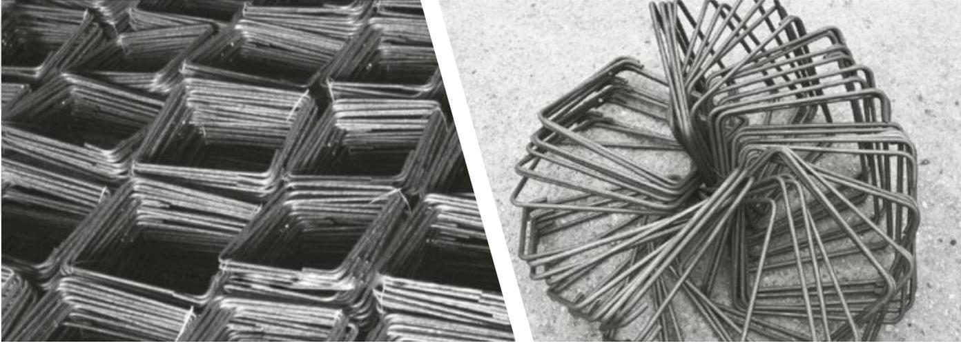
Los estribos son barras de acero dobladas en diferentes formas, que se colocan perpendicularmente a la armadura longitudinal. Sirven para posicionar varillas en el armado de castillos y vigas.
